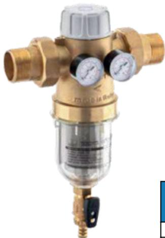
L'acqua da filtrare, una volta introdotta all'interno della testata, attraversa l'elemento filtrante rilasciando sulla superficie esterna dello stesso le particelle con diametro superiore al grado di filtrazione che si è scelto per quanto riguarda l'elemento filtrante. L'acqua filtrata viene quindi inviata in uscita al filtro.
