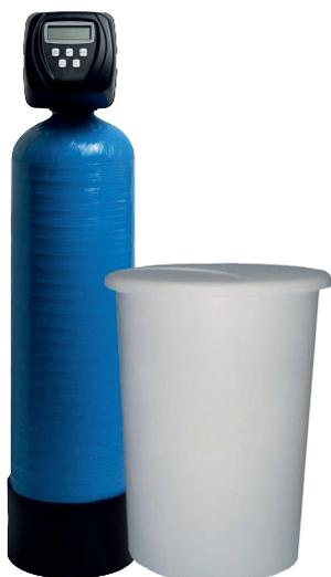
VPRO-SP viene utilizzato per il trattamento dell'acqua potabile basati sul principio delle resine a scambio ionico mediante il quale vengono sostituiti gli ioni di calcio e magnesio (ioni dei sali costituenti la durezza) con equivalenti ioni di sodio. Al fine di far fronte alle diverse esigenze di impiego,
