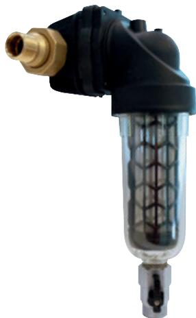
L'acqua da filtrare, una volta introdotta all'interno della testata, attraversa l'elemento filtrante rilasciando sulla superficie esterna dello stesso le particelle con diametro superiore al grado di filtrazione che si è scelto per quanto riguarda l'elemento filtrante.
